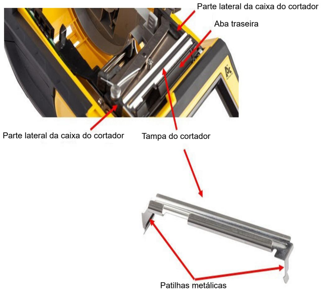
1. Segure na tampa a partir da parte superior com a parte de corte voltada para o ecrã de visualização (afastada do poço de consumíveis de etiqueta).
