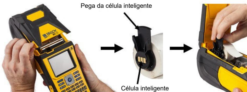
3. Se utilizar algo que não seja um consumível de etiqueta com 51 mm (2 pol.) de largura, deslize a guia de etiquetas para a esquerda até esta se ajustar confortavelmente contra o rolo de etiquetas e encaixar na posição correta.
