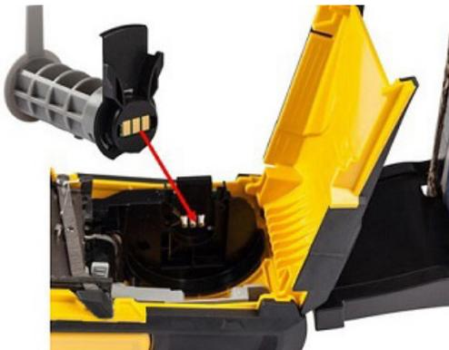
6. Puxe a extremidade solta do volume de consumíveis de etiqueta para fora da caixa, passe-a sobre o tabuleiro e por dentro do caminho de alimentação do volume de etiquetas na impressora.
