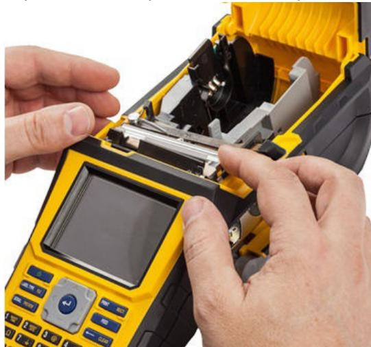
2. Substitua a lâmina ou limpe-a utilizando uma cotonete pré-humedecida do kit de limpeza Brady PCK-6.
