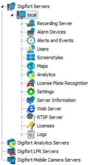
**Menu de configurações:** Neste menu são exibidas as configurações disponíveis para o servidor selecionado. As configurações são exibidas em formato de árvore, ou seja, com itens e sub-itens. Para acessar alguma configuração do servidor clique no menu desejado. As configurações relacionadas ao item selecionado serão exibidas na área reservada, à direita deste item.
