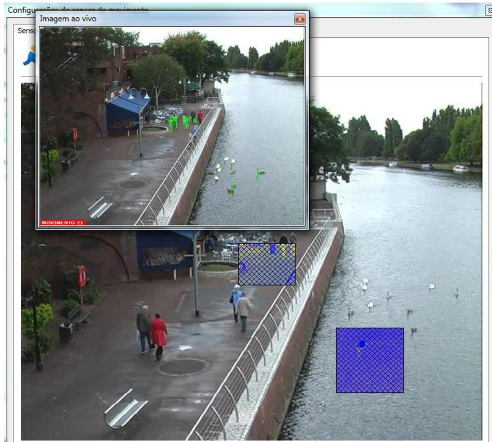
A figura abaixo demonstra o funcionamento do sensor de movimento com seleção de áreas não sensíveis ao movimento:
