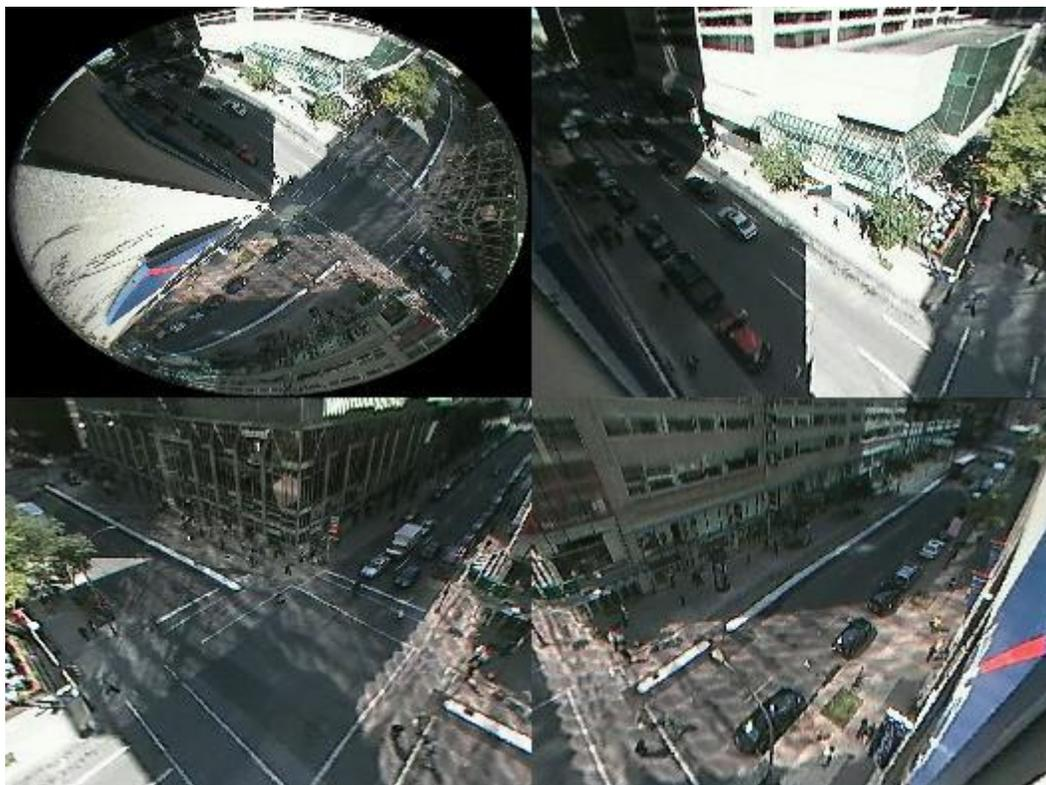
**OBS:** Lentes panamórficas não funcionam como as lentes "fish eye", ou seja, uma câmera fish eye deve ser integrada de acordo com seu fabricante. A vantagem da lente panamórfica é que ela pode ser utilizada em qualquer câmera com sensor de 1/3.
