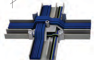
Exemplo de passagem dos cabos com uso da blindagem eletromagnética.
