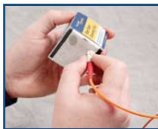
Figura 15 – Método de limpeza “da parte úmida para a parte seca”. Aplique um pouco de solvente na borda inicial do dispositivo limpador. Segure o conector da terminação perpendicularmente e passe a face do ponto úmido para a área seca.
