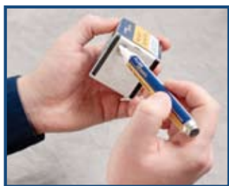
Figura 15 – Método de limpeza “da parte úmida para a parte seca”. Aplique um pouco de solvente na borda inicial do dispositivo limpador. Segure o conector da terminação perpendicularmente e passe a face do ponto úmido para a área seca.
