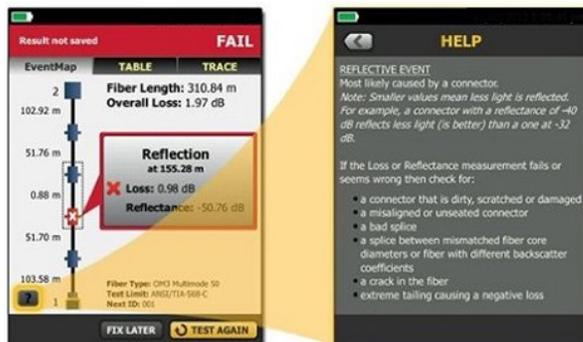
Figura 8. EventMap view with on-screen help. Modern OTDR's automate many of the functions of the OTDR to make it easy for almost anyone to perform analysis like an expert. Porém, há alguns exemplos em que mais conhecimento pode ser usado a fim de analisar mais detalhadamente a fibra e descobrir mais a respeito. As próximas duas seções irão discutir configurações avançadas de OTDR e análise de traços.
