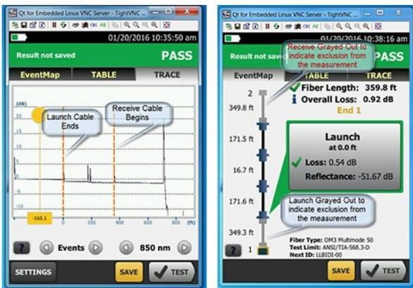
Figura 6. O traço inclui as fibras de lançamento e recepção no início e final do link em teste. O EventMap exibido à direita usa a compensação de lançamento para remover seus efeitos dos resultados do teste.
