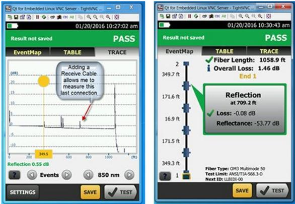
Figura 5. Adicionando fibras de lançamento e recepção na extremidade distante do cabo permite que o OTDR meça a perda do primeiro e do último conector no link. Porém, os técnicos e as pessoas que recebem os resultados do teste não desejam que as medidas dos cabos de Lançamento e Recepção sejam incluídas em seus relatórios. O relatório do OTDR lhe permite compensar (na verdade, remover) os cabos de lançamento e recepção, assim tudo o que é reportado são os resultados do link em teste.
