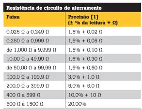
[1] Resistência de loop sem indutância, condutor centralizado e perpendicular à garra.
