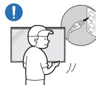
Antes de mover o produto, desligue o interruptor e desconecte o cabo de alimentação e todos os outros cabos conectados.
