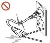
**Enquanto o plugue de energia estiver conectado a uma tomada de energia, não insira um palito ou outro condutor em uma tomada de energia restante. Além disso, após desconectar o plugue de energia da tomada, não toque nos pinos do plugue imediatamente.**
